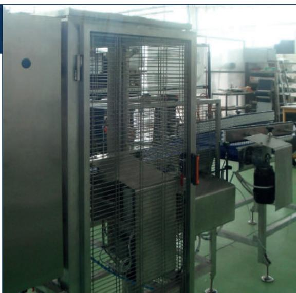
Materiale di costruzione: Acciaio inox AISI304/316 e POM-C blu
