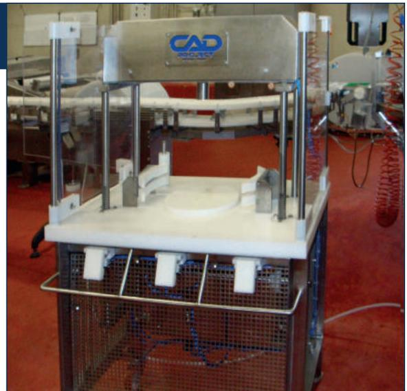
Materiale di costruzione: Acciaio inox AISI304/316 e POM-C blu
